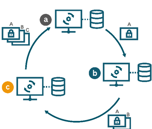
Stap IV Berekeningen worden een voor een door de data stations uitgevoerd
